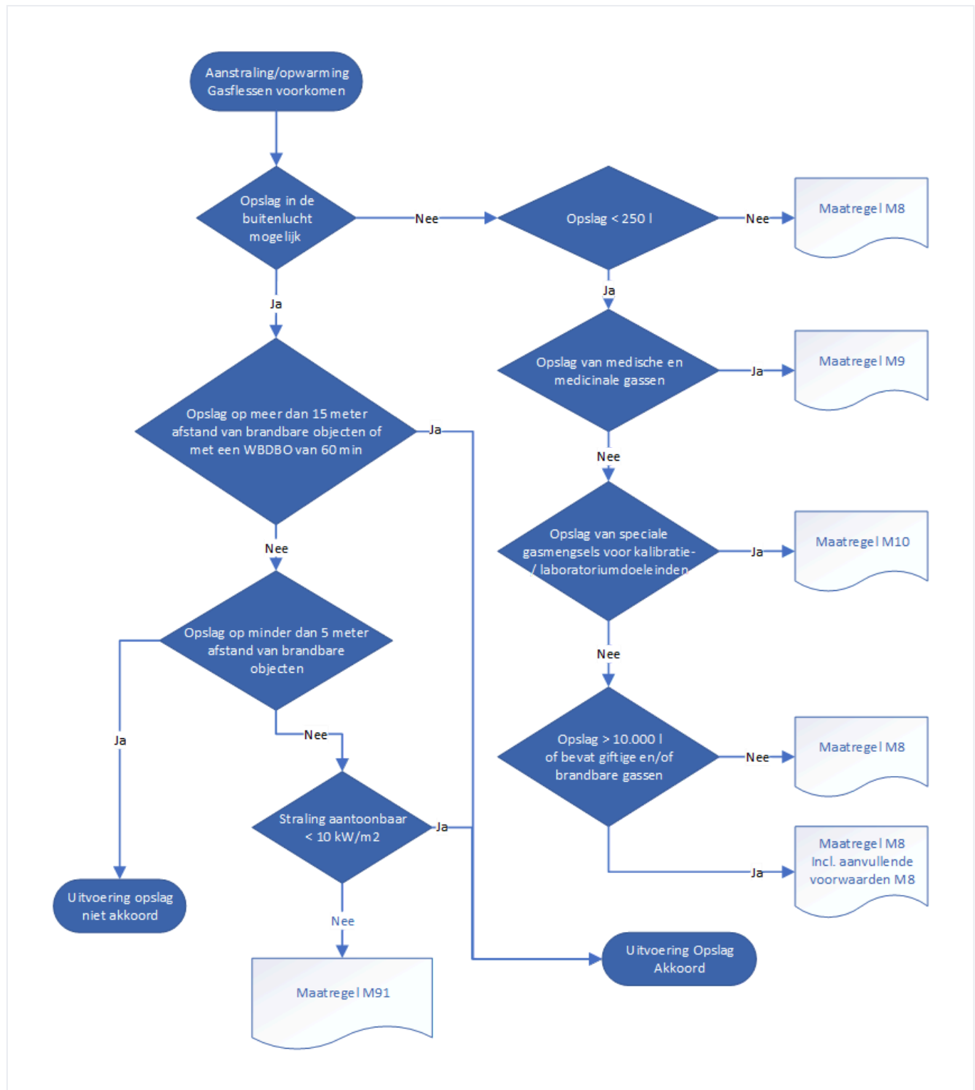
Afbeelding 3 – Stroomschema opslag gasflessen
