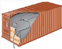
Figuur 1 Doorsnede flexitainer. (Bron figuur: auteur)
